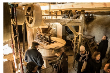
Le moulin à farine avec sa potence pour soulever la meule tournante
