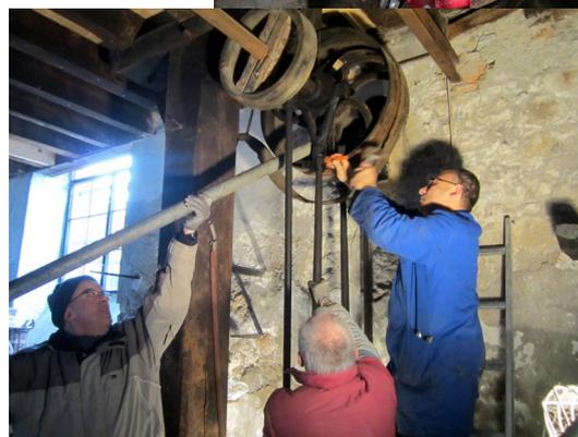
En parallèle, le nettoyage du mécanisme de la meule à huile de noix a commencé ainsi que le démontage de la mécanique de remuage de la pâte de noix sur le fourneau.
