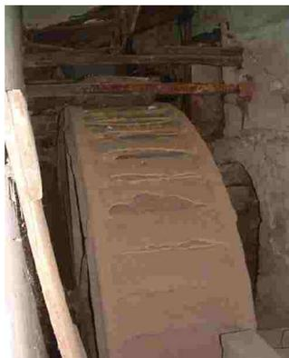
La roue a dû tourner des années pour être recouverte d'une telle couche de calcaire. L'eau arrivant par derrière subit un virage à 180 degré pour attaquer les aubes dans le bon sens.
