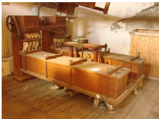
Plansichter du moulin des Ayes composé de 2 blocs de tamis et d'un contrepoids à vilebrequin au milieu
