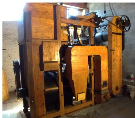
s'en est suivi le décapage des 3 élévateurs, de l'arbre moteur et du cabestan monte-charge ainsi que de l'humidificateur.
