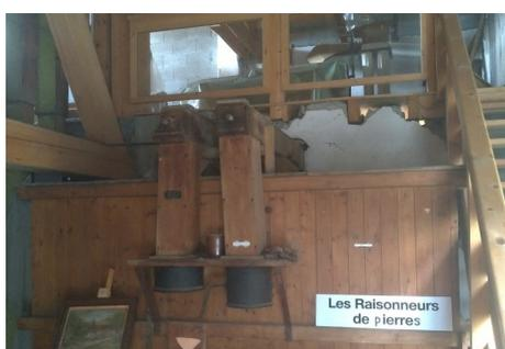
Au rez-de-chaussée, il est envisagé de recréer une réplique de meule à l'ancienne, avec une archure son auget et sa trémie ce qui donnerait du charme, comme le système de régulateur à boules de watt qu'il faut reconnecter à l'arbre de puissance.
