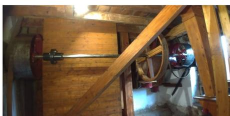
Restent à réviser ou changer les courroies et surtout à remettre le moteur électrique en état et le raccorder.
